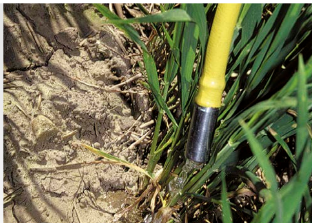
Obciążnik ze stali nierdzewnej przy węży rozlewowym
